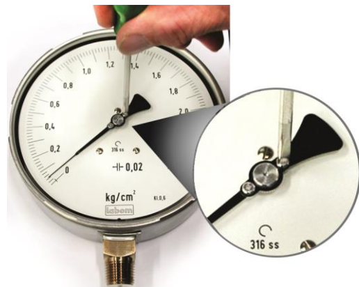
Abbildung 5: Nullpunktkorrektur
