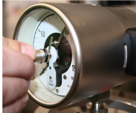
Abbildung 4: Einstellen der Kontakte
