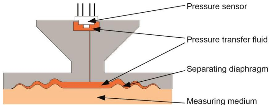
*Abb. 1 Diaphragm seal principle*
