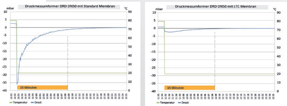
Abbildung 3: Links die (fehlerhafte) Auslenkung ohne LTC-Membran während die heiße Flüssigkeit ausgeleitet und die kalte Flüssigkeit eingefüllt wird. Rechts der gleiche Prozess mit LTC-Membran: Der Temperaturfehler ist fast vollständig verschwunden, die Füllhöhe kann jederzeit zuverlässig abgelesen werden.
