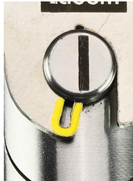
Abbildung 3: Ansicht vor und nach Verbiegen der Federlasche (entscheidender Bereich gelb hervorgehoben)
